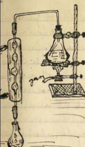
Per distillare un liquido, è sufficiente di farlo bollire e di contenere in un aliguardo i vapori che vengono formati. Se l'acqua naturale viene trattata così, si ottiene allora l'acqua distillata.
